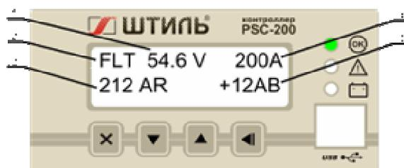
1 – напряжение системы, 2 – режим работы системы, 3 – суммарный ток выпрямителей, 4 – ток нагрузки, 5 – ток батарей
